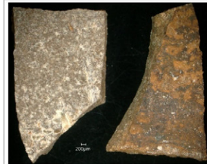
Abb. 01: Probepartikel. Links: opake Masse mit einem weißen Oberflächenfilm. Rechts: gegenüberliegende Seite mit Rostablagerungen.
