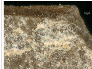
Abb. 03 / 04: Oberflächendetails. Links: Belag aus organischen Komponenten. Rechts: Dunkle Schicht mit Rost auf der einen Seite (Armierung) und gelbbraunen Eisenverbindungen darunter (Pfeilmarker).
